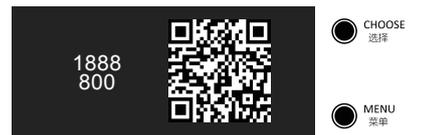
长按“菜单”键3秒，屏幕将显示主机电子二维码。可通过APP扫描此二维码添加主机（与标签二维码相同功能）。再长按“菜单”键3秒，屏幕切换回主界面。
